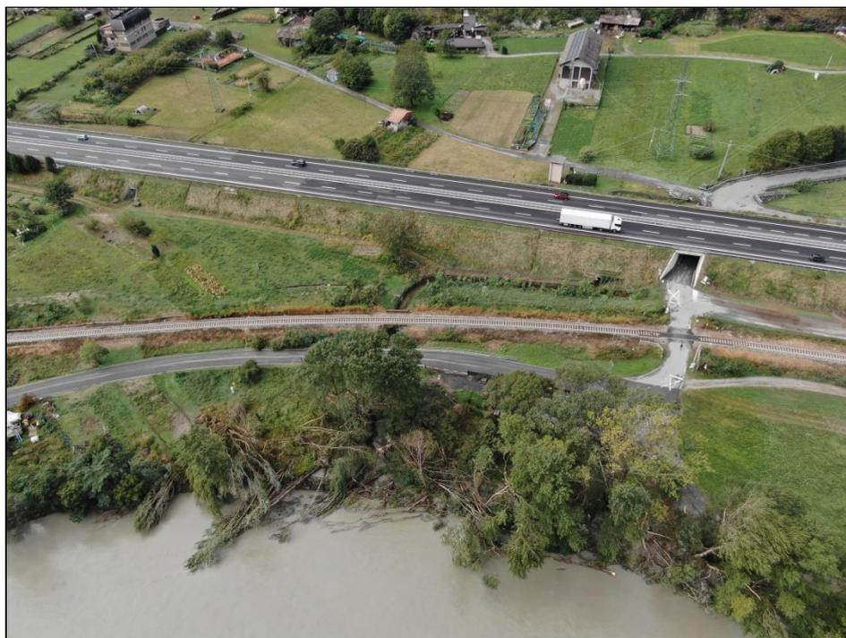
**Dora Baltea, Hône dettaglio del fenomeno di erosione spondale con esondazione nei prati limitrofi e piante schiantate.**
