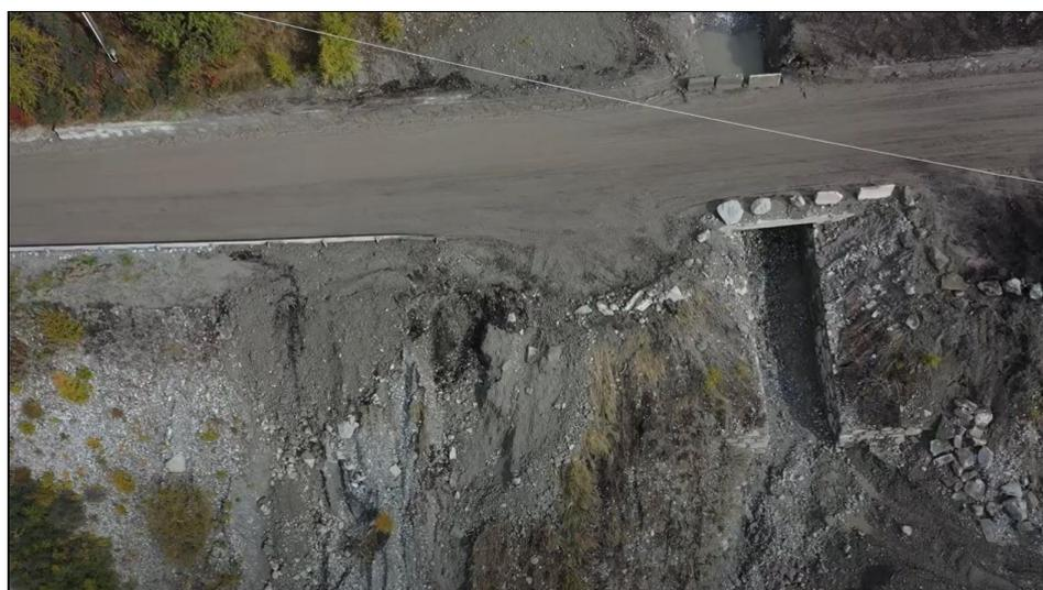
**Cogne, T. Urthier erosioni diffuse e fenomeni franosi innescatisi lungo la sponda destra idrografica in corrispondenza dell'impluvio di Costa del Pino.**
