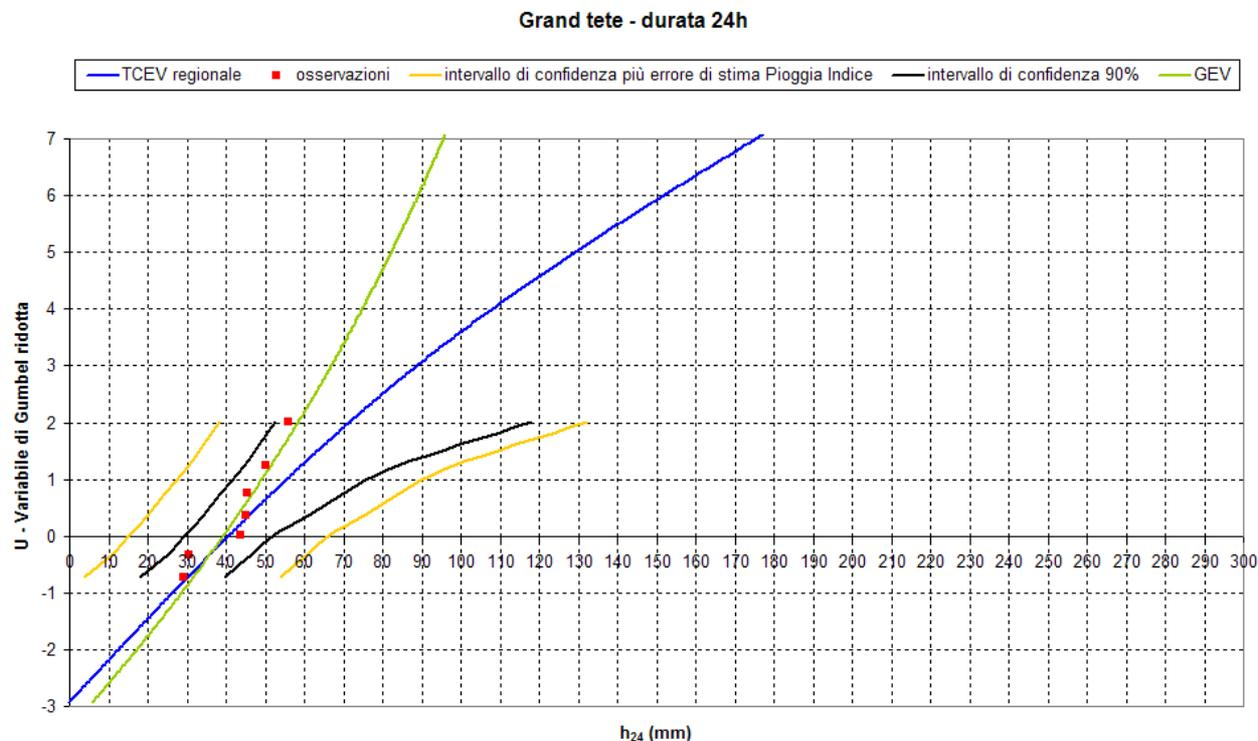
**Figura 132: Confronto puntuale per la durata di 24 h tra la TCEV regionale (curva in blu) calcolata dal Modello CIMA e la GEV (curva in verde) calcolata dal modello POLIMI per la stazione pluviometrica di Gran Tete, con indicazione delle osservazioni di pioggia (quadrati in rosso), dell'intervallo di confidenza 90% della TCEV regionale (curve in nero) e dell'intervallo di confidenza della TCEV comprensivo anche dell'errore di stima della pioggia indice (curve in giallo ocra).**
