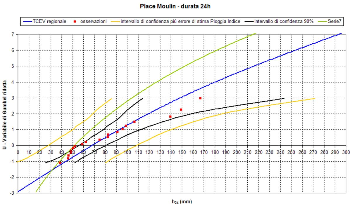
**Figura 44: Confronto puntuale per la durata di 24h tra la TCEV regionale (curva in blu) calcolata dal Modello CIMA e la GEV (curva in verde) calcolata dal modello POLIMI per la stazione pluviometrica di Place Moulin, con indicazione delle osservazioni di pioggia (quadrati in rosso), dell'intervallo di confidenza 90% della TCEV regionale (curve in nero) e dell'intervallo di confidenza della TCEV comprensivo anche dell'errore di stima della pioggia indice (curve in giallo ocra).**
