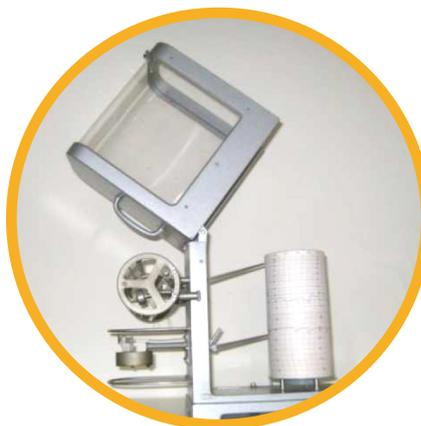
Lo strumento visualizzato nell'immagine si chiama termoigrografo. Che cosa misura?
